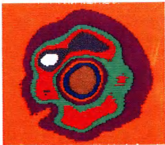
Рис. 77. Видеограммы, показывающие изменения распределения яркости излучения в дальнем поле на выходе световода типа «кварц—кварц» для одноволоконного кабеля, намотанного на мандрелы различного диаметра:
