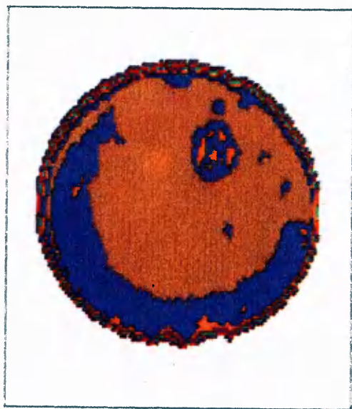
Рис. 78. Видеогаммы структуры светового пучка в плоскости выходного торца волокна типа «кварц—полимер»:
